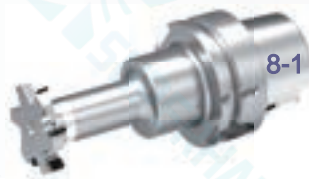
8-1 反铣刀 n=8000r/min fz=0.05mm/z
