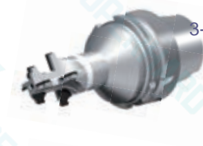
3-2 反倒角铣刀 n=3500r/min fz=0.06mm/z
