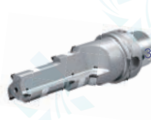
3-1 阶梯钻铰刀 n=4500r/min fz=0.03mm/z
