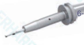
6-3 阶梯铰刀 n=4200\text{r/min} fz=0.015\text{mm/z}
