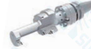
6-4 密齿多阶梯铰刀 n=8000\text{r/min} fz=0.05\text{mm/z}
